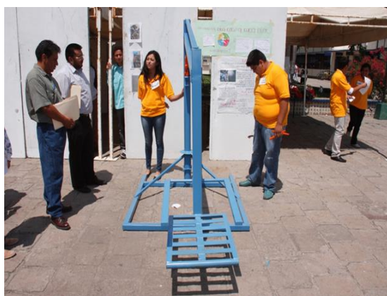
Grúa de acceso a piscina para personas con discapacidad
